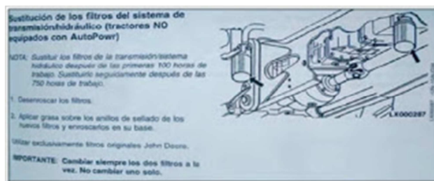
Figura 47. Procedimiento para cambio de filtro hidráulico (fuente: JHON DEERE ).
