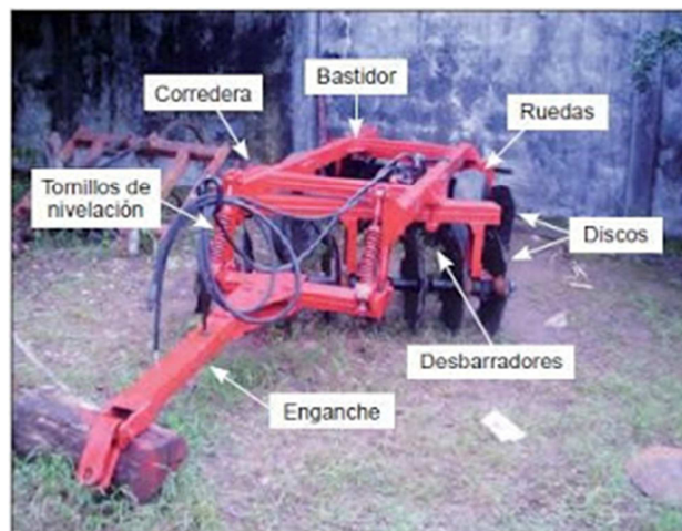
Figura 15. Partes de la rastra de discos (foto del autor). De acuerdo con el peso que soporta cada disco, las rastras se clasifican así:
