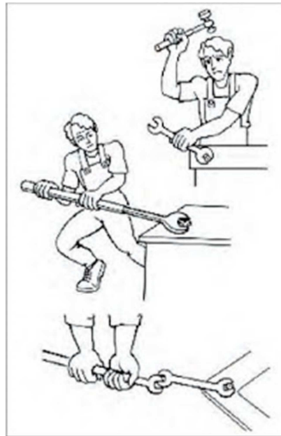
Figura 10. Manejo inadecuado de las llaves (Fuente Universidad de Atacama)
