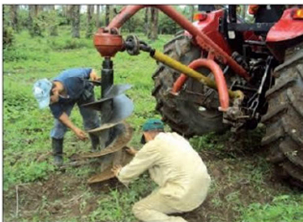
Figura 20. Partes del ahoyador mecánico (foto de Pedro Nel Franco).
