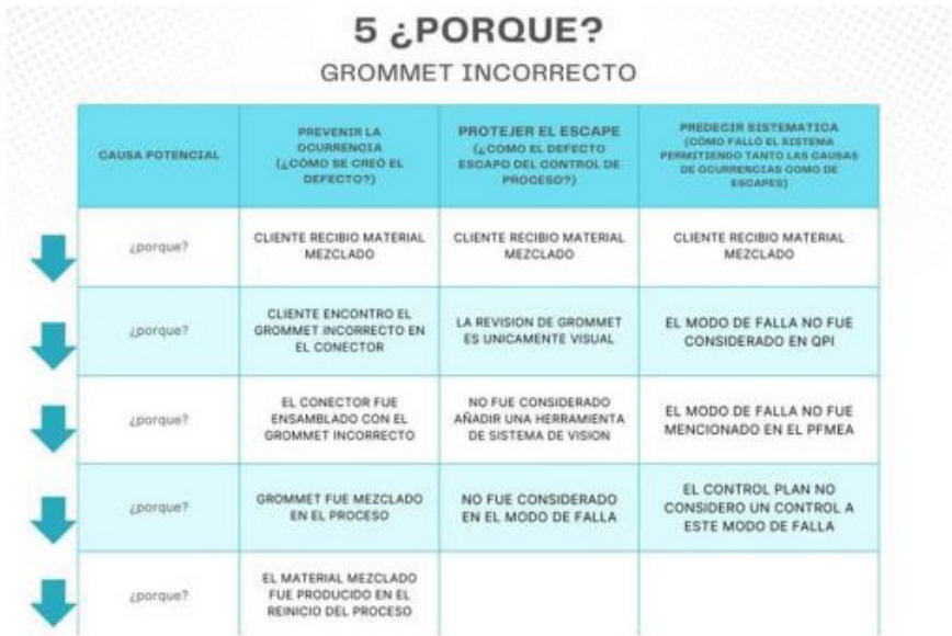
Figura 9. Aplicación de los 5 porqués.
