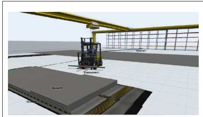
Figura 6. Simulación en el software FlexSim para determinar los tiempos que se usarían para desplazar el material entre cada nave.
