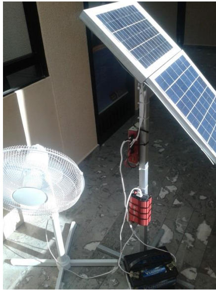
Figura 8. Prototipo productor de energía eléctrica elaborado a partir de material reciclado.
