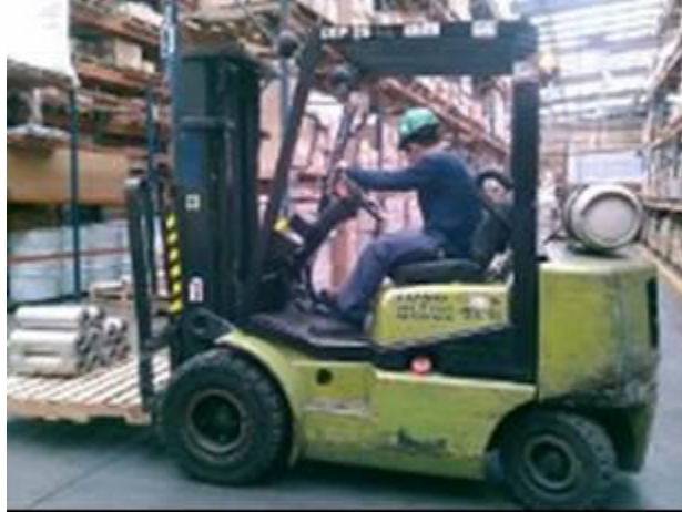
Figura 4. Problema de vibración en el montacargas.
