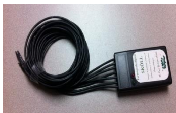
Figura 1. Termógrafo digital Sköll.
