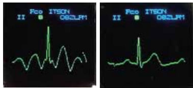
Figura 16 a) Señal sin procesamiento más ruido de 120 Hz y b) Señal procesada
