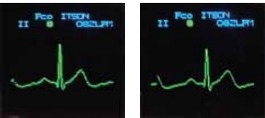
Figura 19 a) Señal sin procesamiento más ruido base line y b) Señal procesada
