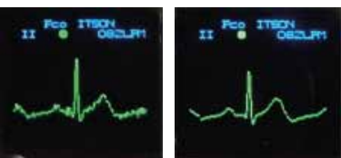
Figura 20 a) Señal sin procesamiento más ruido muscular y b) Señal procesada
