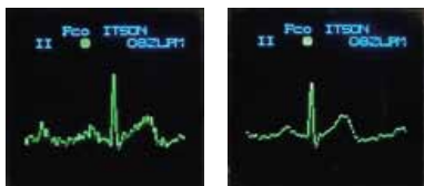
Figura 18 a) Señal sin procesamiento más ruido Gaussiano y b) Señal procesada
