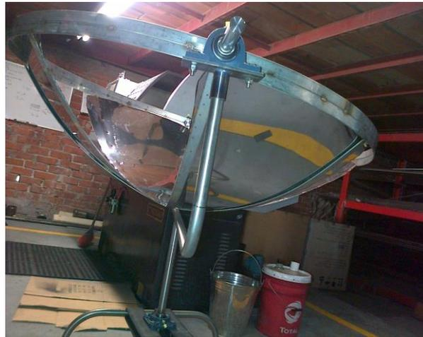
Figura 15. Colocación de colectores y rodamientos.
