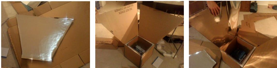
Figura 10. Panel reflejante, estructura y ensamble del material aislante y reflejante.
