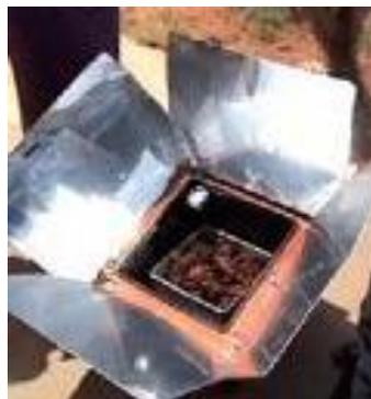
Figura 11. Caja solar con planos paraboloide, vista frontal.
