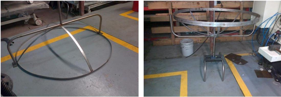
Figura 14. Aro base de la estufa solar paraboloide y estructura terminada.
