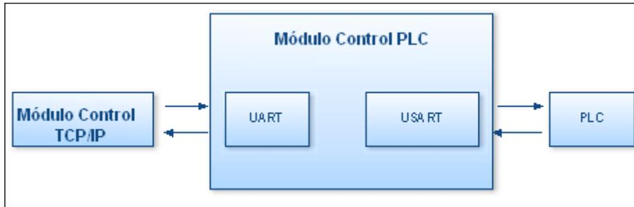
Figura 3. Esquema del hardware del módulo de control PLC
