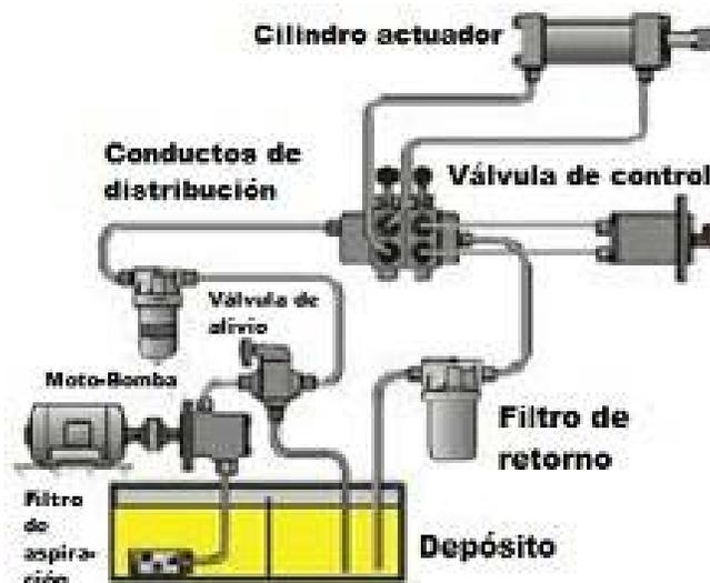
Los actuadores son dispositivos capaces de generar una fuerza a partir de la transformación de la energía hidráulica, neumática o eléctrica. Estos, al recibir una orden de un controlador, generan una salida la cual acciona un elemento final del control, como una válvula para accionar un elemento final de un control, por ejemplo, el actuador.
