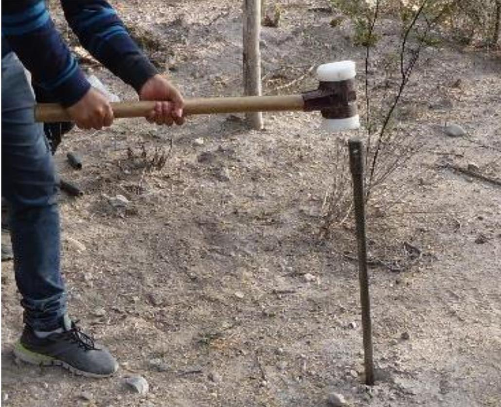
Figura 3. Muestreo vertical de sedimentos y extracción de un perfil de subsuelo.
