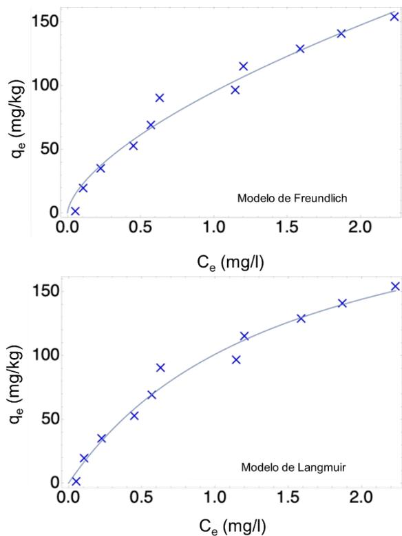
**Figura 3.** Ajuste de los datos experimentales de la adsorción de F<sup>-</sup> en suelo Vertisol a los modelos de Langmuir y Freundlich bajo condiciones de pH 6
