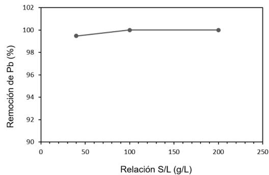
d) Condiciones:  $[Pb]_0 = 10 \text{ mg/L}$ ,  $T = 25^\circ \text{ C}$ , tiempo = 5 min, y  $\text{pH} = 9$ .
