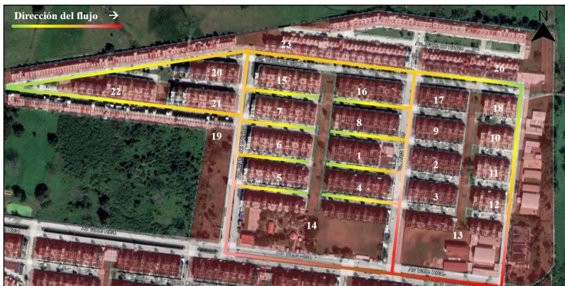
Figura 2. Distribución de manzanas en el Sector 4 con el flujo de escorrentía hacia el canal de drenaje.
