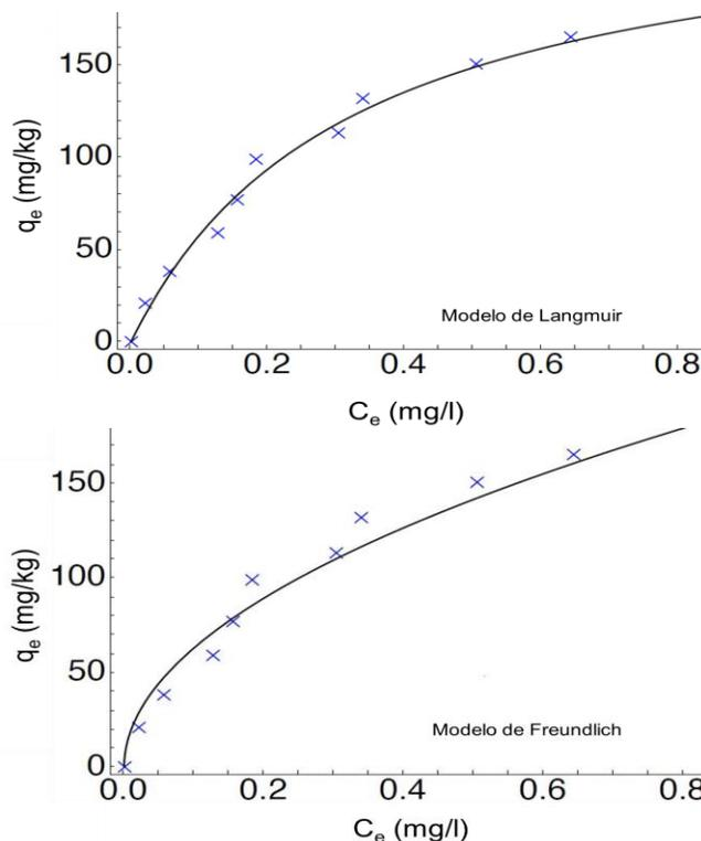
**Figura 2.** Ajuste de los datos experimentales de la adsorción de F- en suelo Vertisol a los modelos de Langmuir y Freundlich bajo condiciones de pH 4
