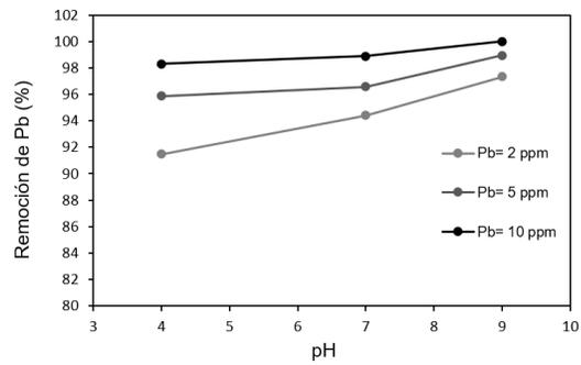
b) Condiciones:  $T = 25^\circ \text{ C}$ , Zeolita = 5 g y tiempo = 5 min.
