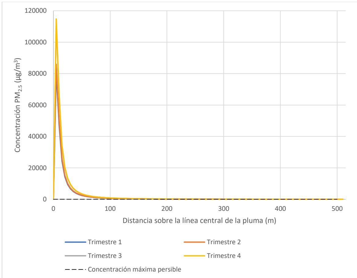
**Figura 4.** Concentraciones de PM<sub>2.5</sub> sobre la línea central de la pluma durante los cuatro trimestres del año producidas por el fogón tipo U.
