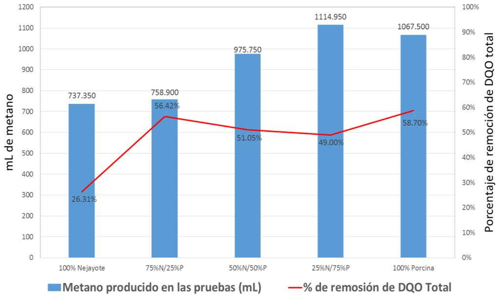
**Figura 3.** Producción de metano (CH<sub>4</sub>) comparada con la DQO total removida
