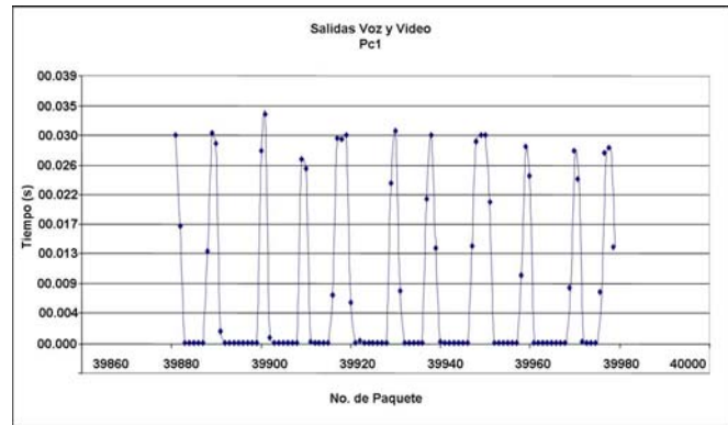
Fig. 6 Tiempo de espaciado entre paquetes de transmisión de Audio y Video.
