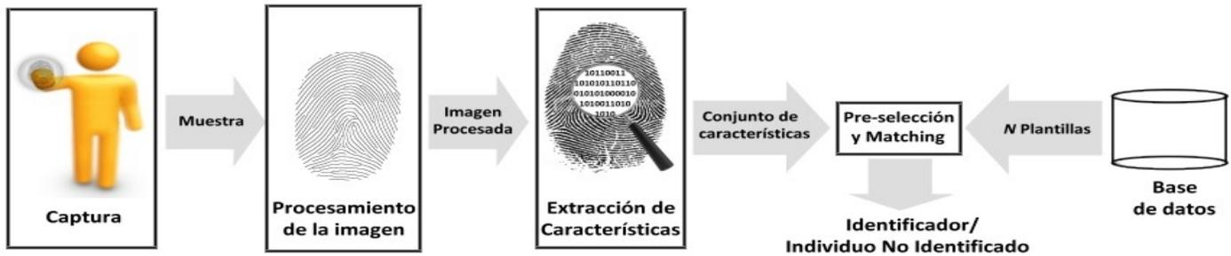
Fig. 1. Diagrama de bloques de un sistema de identificación de huellas dactilares.
