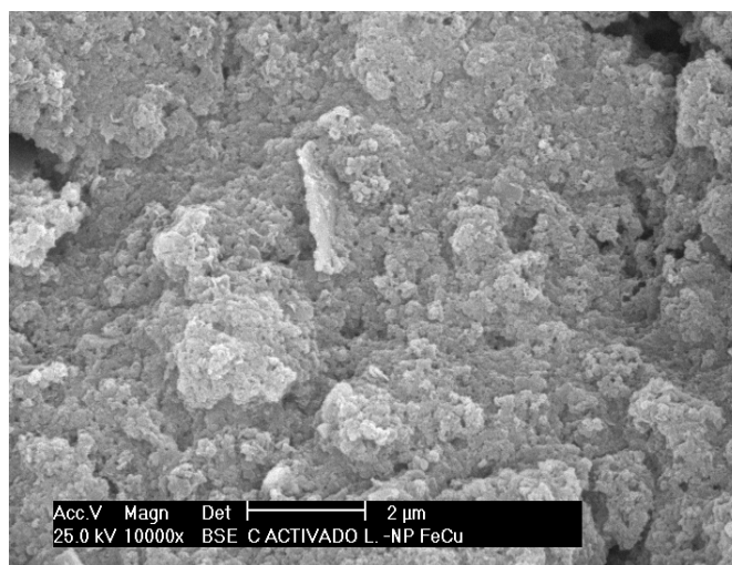
Figura 6. Micrografía de compuesto preparado con carbón activado proveniente de la pirólisis de lodos residuales y la nanoaleación de Fe/Cu, tomada con electrones retrodispersos, a 10000 x y 25 kV de voltaje.
