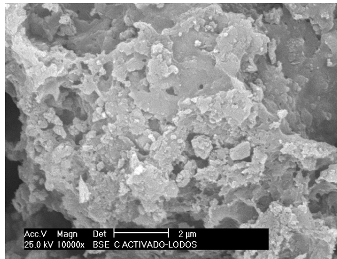
Figura 4. Micrografía del carbón activado proveniente de la pirólisis de lodos residuales, tomada con electrones retrodispersados, a 10000 x y 25 kV de voltaje.
