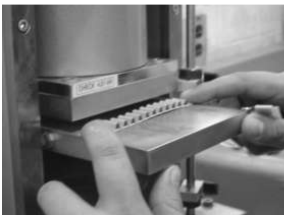
Figura 6. Pruebas de compresión en papel corrugado.
