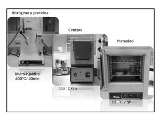
Figura 2. Análisis proximal de guitosano.
