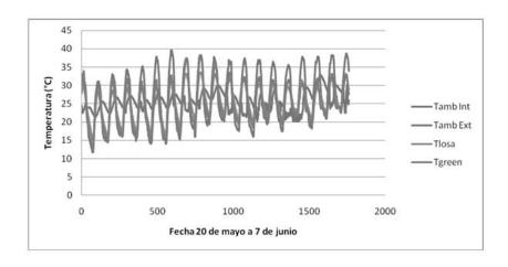
Figura 9. Diferencial de temperatura en sistema Azotea Verde en verano.
