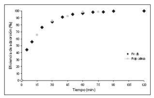
Figura 6. Comportamiento de adsorción de perlas de quitosano entrecruzado con t ripolifosfato en función del tiempo. Para Fe (II) se utilizaron 3 g de perlas húmedas y 100 ml de solución a pH 5. Para rojo allura se utilizaron 14 g de perlas húmedas y 50 ml de solución a pH 3.
