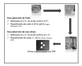
Figura 3. Entrecruzamiento de quitosano con tripolifosfato de sodio.
