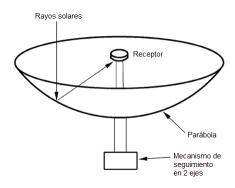
Figura 5. Disco parabólico.
