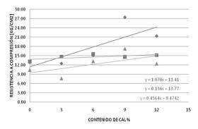
Figura 2. Resistencia de especímenes para diferentes contenidos de cal.
