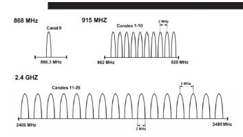
Figura 3. Representación de los canales de radio 802.15.4 - Zigbee.
