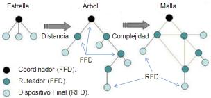
Figura 2. Topologías de Red Zigbee.
