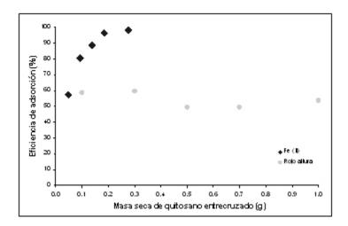
Figura 7. Comportamiento de adsorción de perlas de quitosano entrecruzado con tripolifosfato en función de la masa del quitosano entrecruzado. Para Fe (II) se utilizaron 100 ml de solución a pH 5 y un tiempo de 70 min. Para rojo allura se utilizaron 50 ml de solución a pH 3 y un tiempo de 60 min.
