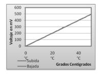
Figura 7. Comportamiento lineal del sensor de temperatura.
