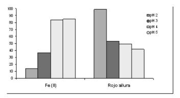
Figura 5. Comportamiento de adsorción de perlas de quitosano entrecruzado con ripolifosfato en función del pH. Para Fe (II) se utilizaron 3 g de perlas húmedas, un tiempo de 30 min y 100 ml de solución. Para rojo allura se utilizaron 14 g de perlas húmedas, un tiempo de 15 min y 50 ml de solución.
