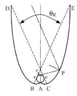
Figura 3. Colector parabólico compuesto.
