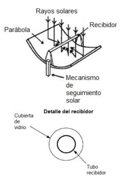
Figura 4. Colector cilindro parabólico.
