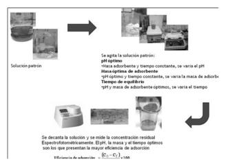
Figura 4. Determinación de condiciones óptimas de adsorción.
