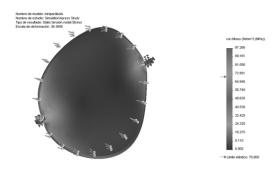
Figura 6. Simulación del concentrador recibiendo la fuerza del viento, caso extremo.
