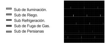
Figura 6. Pulsos de acceso a los subsistemas.
