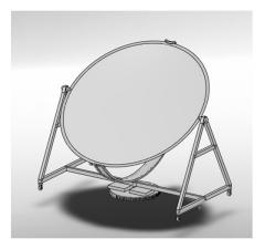
Figura 8. Concentrador, geometría de la base y sistema de posicionamiento.
